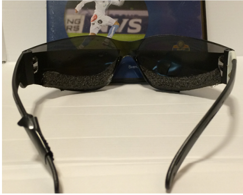
Figur 5 – Specialdesignade glasögon. Den non-visuella återkopplingen illustreras genom den del av glasögonen inom vilket det inte går att skymta bakgrunden. Skumgummiremsan på glasögonens nedre kant eliminerade möjligheten att se under kanten på glasögonen.
