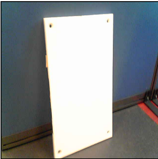
Figur 3 Polyetenplattan som används i mätningförsöket
