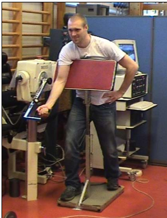
Figur 3. Den experimentella uppställningen med försöksperson, dynamometer och biceps-ställning. I bakgrunden dator för registrering och datainsamling.
