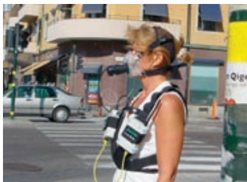
Figur 4. Bilden visar det mobila system som används för att mäta syreupptagning under gång och cykling. Systemet väger knappt 1 kilo och mäter bland annat kontinuerligt syreupptagning, respiratorisk kvot och lungventilation andetag för andetag. Foto: Jane Salier-Eriksson
