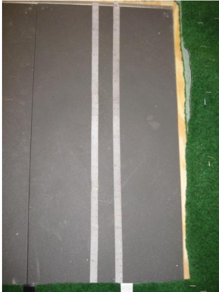
Figur 7. Kraftplattan med tejpmarkering sedd uppifrån.
