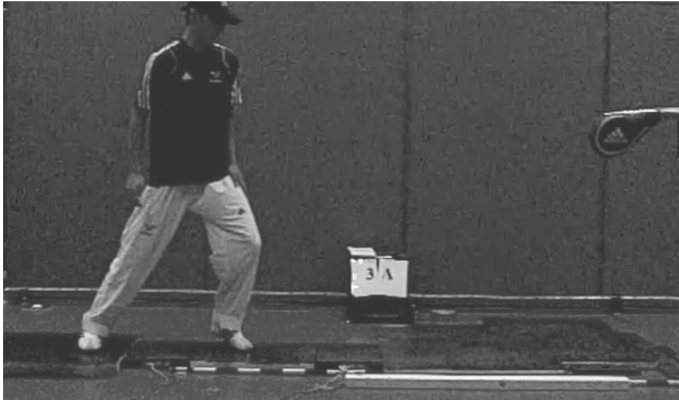
Fig 5. Stepfas (1): Från det ögonblick TP:s bakre fot lämnar underlaget till dess att densamma får kontakt med kraftplattan (datainsamling genom mätning med höghastighetskamera).
